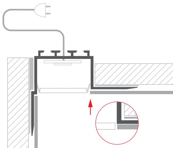
**2.** Установите светодиодную ленту (B) в профиль (A), просуньте через отверстие кабель питания, установите **монтажный** рассеиватель (C) и затем установите заглушки (D).
