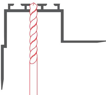
**3.** Закрепите профиль к стене и потолку используя клей или саморезы. Подключите светодиодную ленту к блоку питания.
