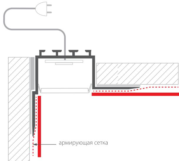
**6.** Снимите монтажный рассеиватель, и установите обычный.
