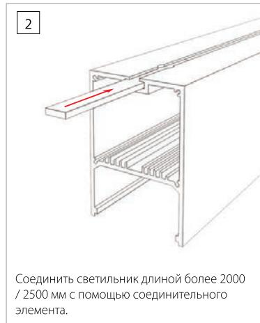
Соединить светильник длиной более 2000 / 2500 мм с помощью соединительного элемента.
