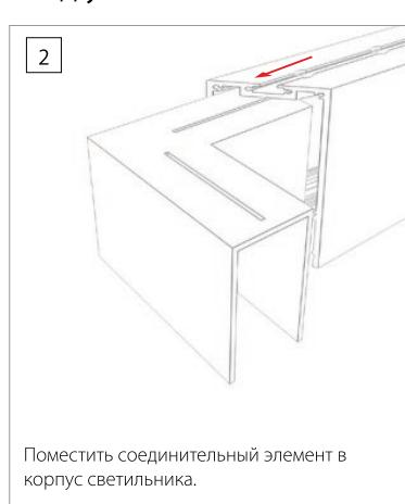
Поместить соединительный элемент в корпус светильника.
