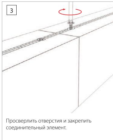
Просверлить отверстия и закрепить соединительный элемент.
