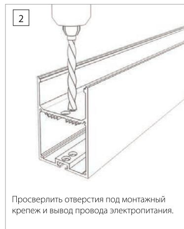
Просверлить отверстия под монтажный крепеж и вывод провода электропитания.
