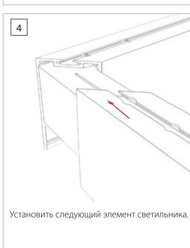
Установить следующий элемент светильника.
