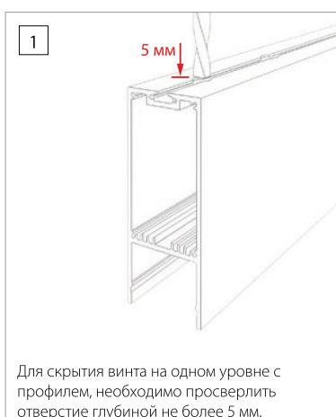
Для скрытия винта на одном уровне с профилем, необходимо просверлить отверстие глубиной не более 5 мм.
