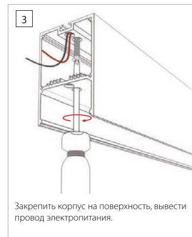
Закрепить корпус на поверхность, вывести провод электропитания.
