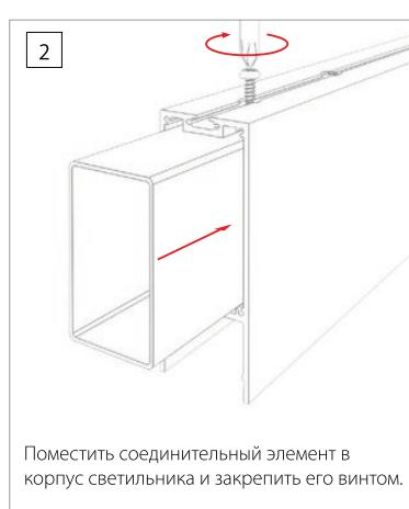
Поместить соединительный элемент в корпус светильника и закрепить его винтом.
