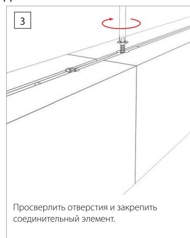
Просверлить отверстия и закрепить соединительный элемент.
