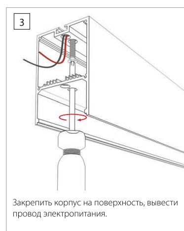
Закрепить корпус на поверхность, вывести провод электропитания.
