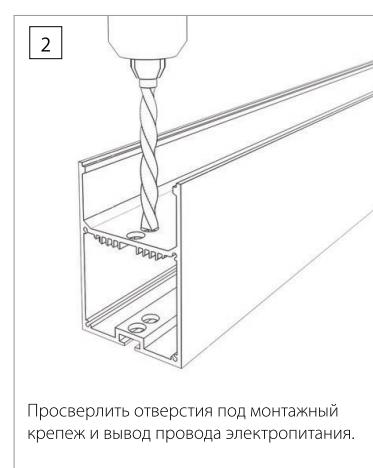
Просверлить отверстия под монтажный крепеж и вывод провода электропитания.
