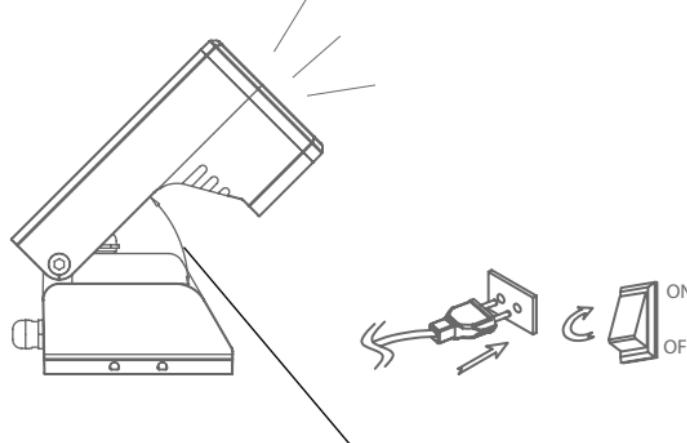
Угол наклона светильника 0-110°
